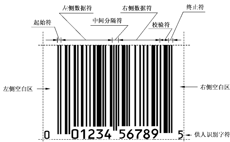
图 C.1 UPC-A 商品条码的符号结构
