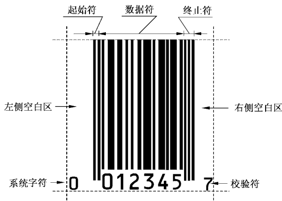
图 C.2 UPC-E 商品条码的符号结构
