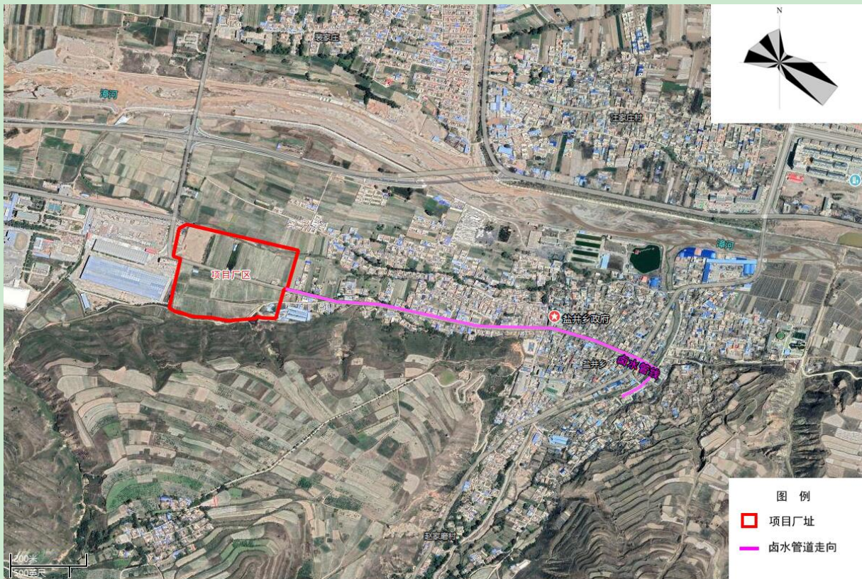
图 2.1-2 卤水管道走向图
